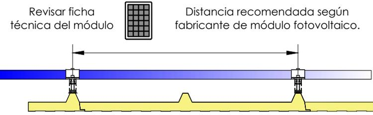
**Fijación de los módulos con los presores centrales y laterales**
